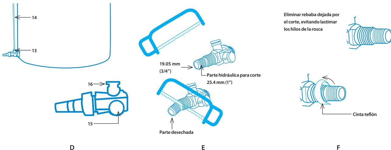
Fig 4. Instalación del Multiconector.
