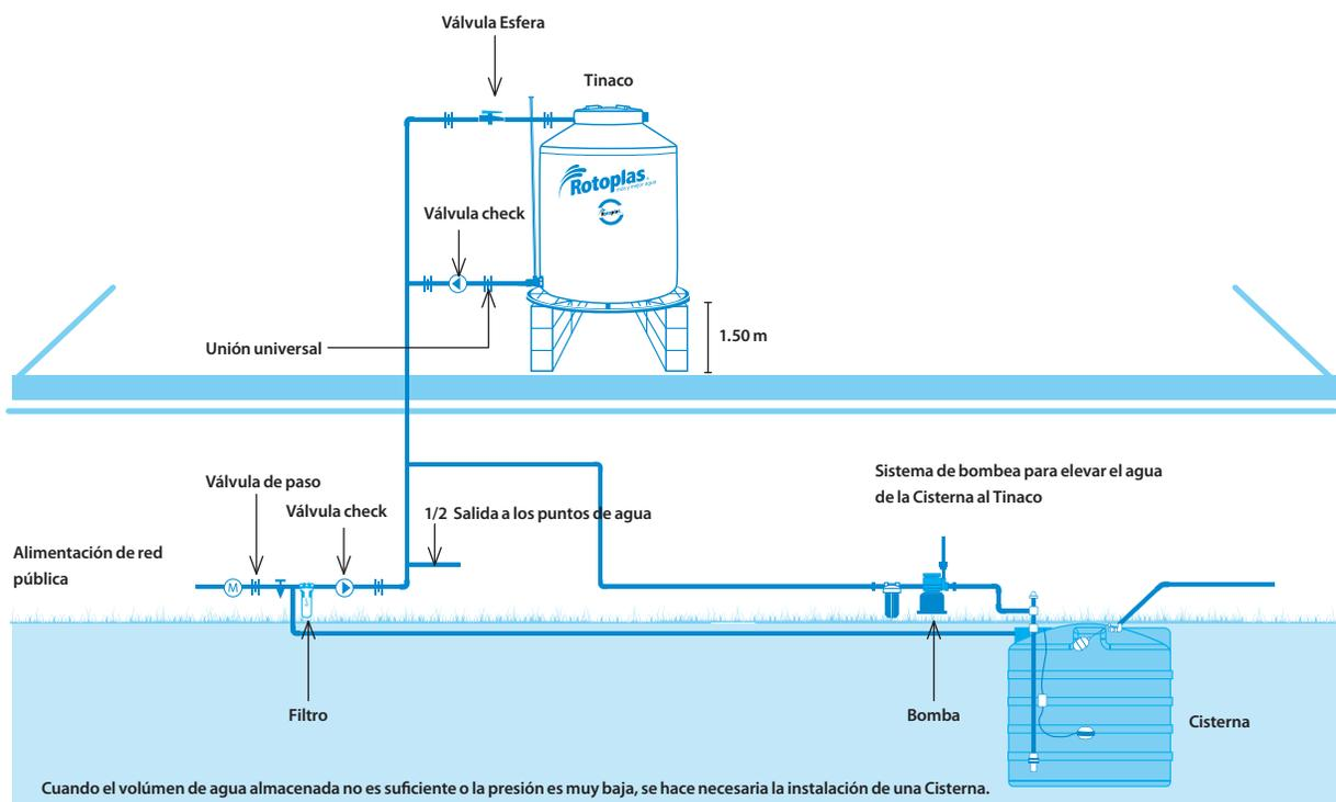
Fig.6. Instalación básica tanque y cisterna.
